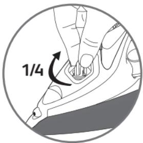
\*CS Odvápnovací systém - čištění (jedenkrát měsíčně) • HU Vízkőképződést gátló rendszer - (havi tisztítás) • SK Odvápnovací systém - čistenie (raz mesačne) • HR Štapić protiv kamenca (čišćenje provoditi jednom mjesecno) • SL Čiščenje vodnega kamna (enkrat mesečno) • RO Curățarea tijei anti-calcar (odată pe lună) • SR Čišćenje ventila protiv kamenca (jednom mesečno) •
